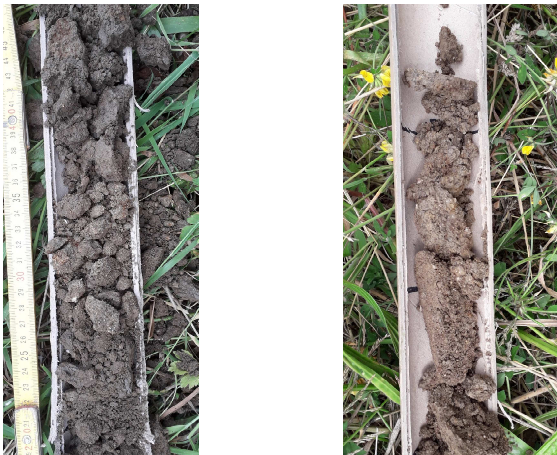
Figure 5 : Exemple de carottages non humide (gauche) et humide (droite). Source : SAFEGE
